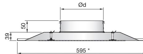
\* Systém zavěšeného podhledu 1, ostatní systémy zavěšených podhledů viz. přehled stropních difuzorů Integra.
